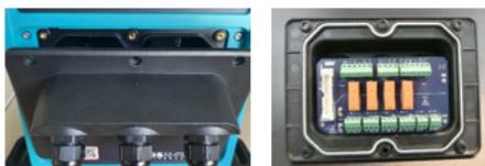
4. Verifique que los prensaestopas para cable preinstalados estén bien apoyados y sujetos y que cuenten con tapas protectoras contra el polvo.
