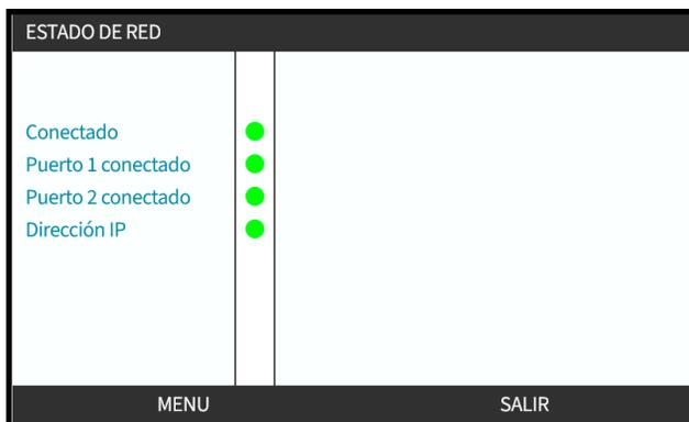
Si la bomba no está funcionando y no se establecen las conexiones con los puertos, no se asigna la dirección IP y el accionamiento no se conecta al maestro.
