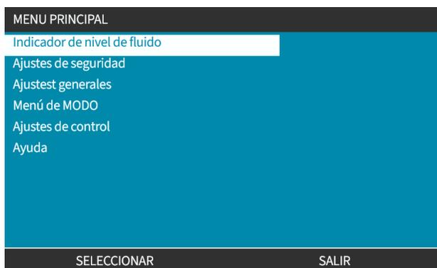
Todos los modelos poseen un indicador de nivel de fluido que permite vigilar el nivel (la cantidad) de fluido restante en el tanque de suministro de entrada durante la operación.
