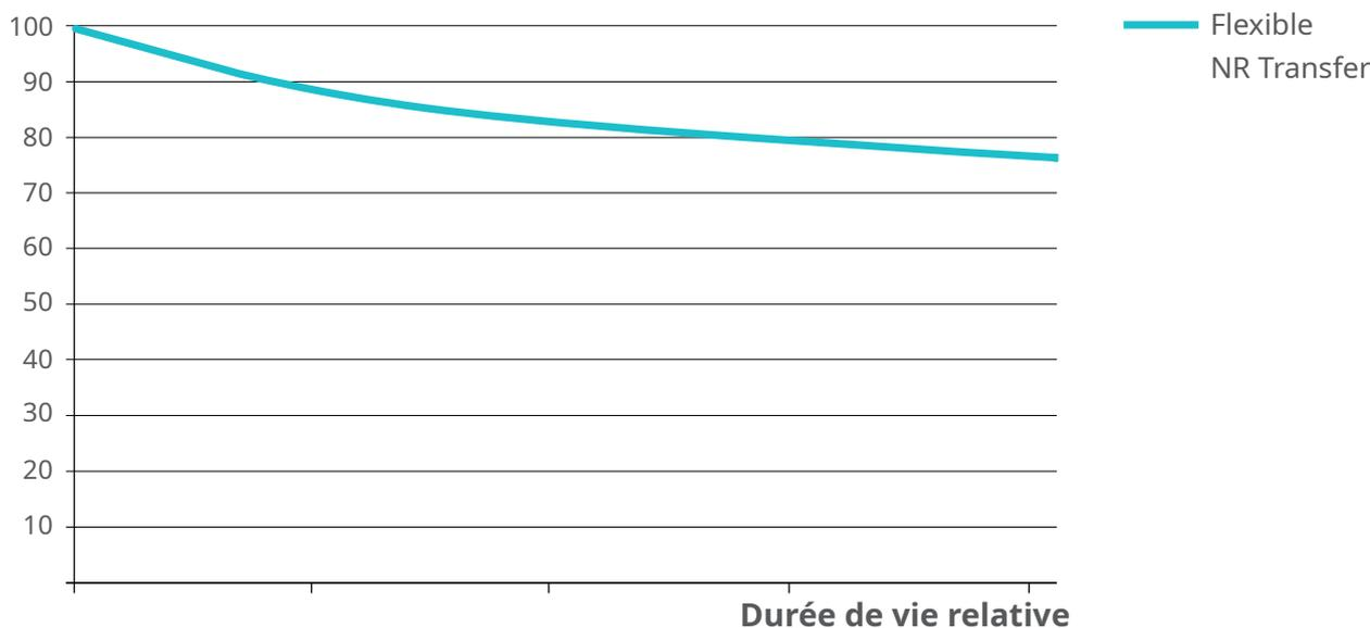
Conditions de test de performance standard : pompage d'eau à 18 °C (64 °F) à 5 bars (73 psi) et 50 tr/min.
