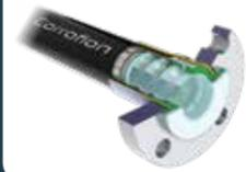
O revestimento com PTFE Corroflon® possui internamente convoluções superficiais que diminuem o atrito da vazão, e um fio de reforço externo que proporciona resistência total a vácuo e a dobras
